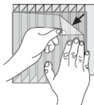
Рисунок 17а. Частичное или полное удаление защитной пленки до или после установки
