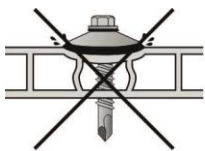
Рисунок 13а. Неправильно — избыток перенапряжения
