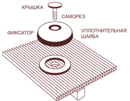
Отверстия должны располагаться на расстоянии не менее 40 мм от края панели. Диаметр отверстия должен быть на 2 мм больше внешнего диаметра стержня фиксатора.
