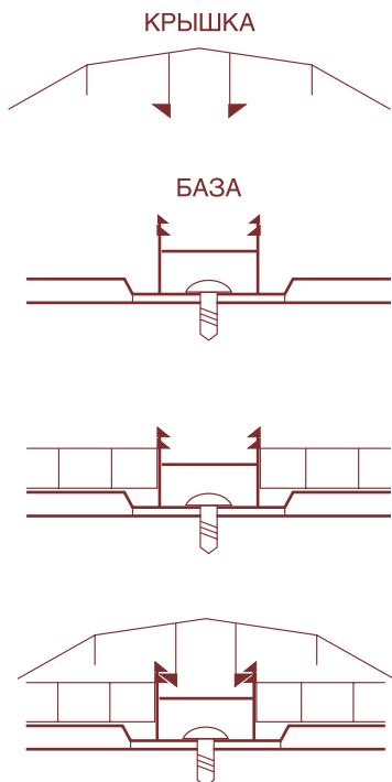
Использование этого профиля позволяет не только надежно соединить листы и закрепить их в конструкции, но и обеспечивает необходимый зазор для термического расширения панелей. Длина профиля – 6 метров. Возможно изготовление профиля нестандартной длины.
